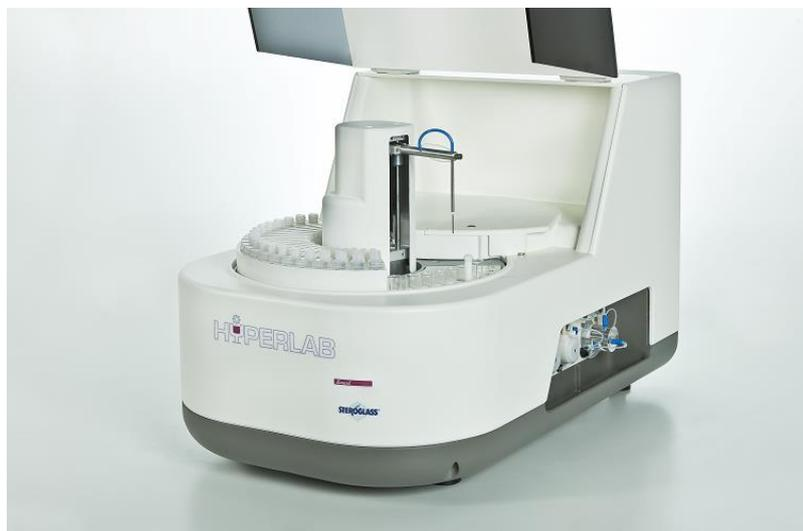
**HYPERLAB SMART** è un sistema compatto e versatile progettato per eseguire in completa automazione le analisi enzimatiche e colorimetriche necessarie al controllo dei processi di Controllo Qualità. I movimenti meccanici dell'*HYPERLAB SMART* sono guidati da motori passo/passo di ultima generazione che si attivano al momento dell'accensione. Il flusso dei liquidi è controllato da tre pompe peristaltiche che entrano in funzione pilotate da software così
